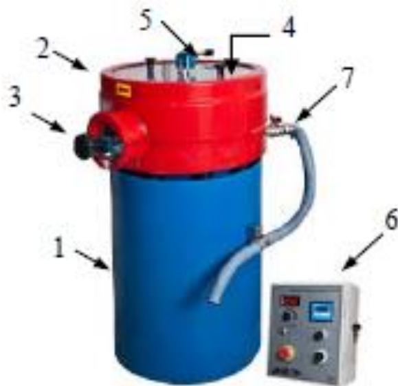
Рис.1 Устройство виброгалтовки AVALON W15F
